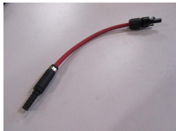
Figuur 13: Rode DC kabel, links H+S minus stekker en rechts Multi-Contact MC4 plus stekker
