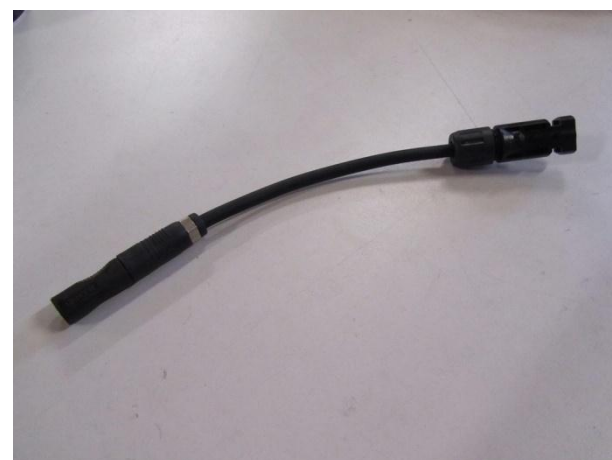
Figuur 14: Zwarte DC kabel, links H+S plus stekkeren rechts Multi-Contact MC4 minus stekker
